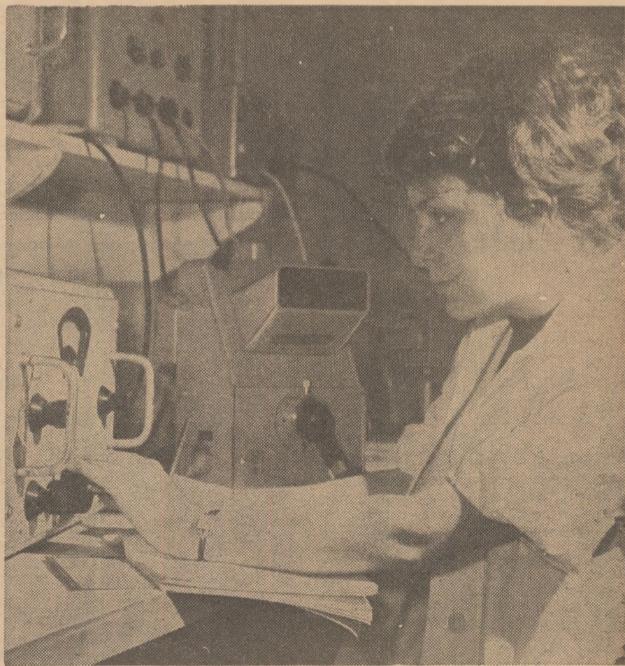
Inginera DESPINA CERVIȘ, cercetător la I.C.V.V. Valea Călugărească, determină în laborator, cu ajutorul spectrofotometrului, densitățile și coloranții vinurilor.
