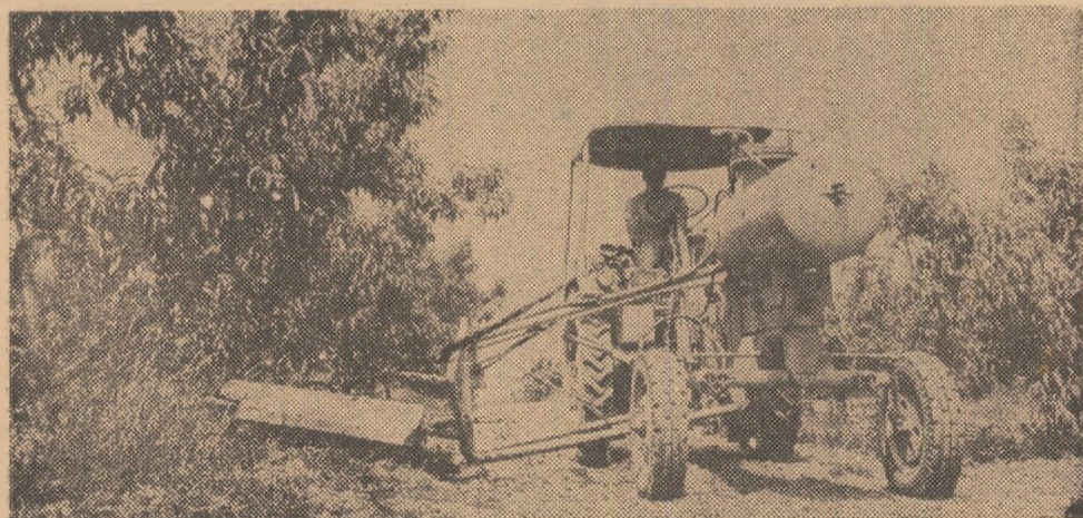
Mașină de aplicat erbicide, în timpul experimentărilor, la Institutul de cercetări horticele din Törökbalint (R. P. Ungară).
