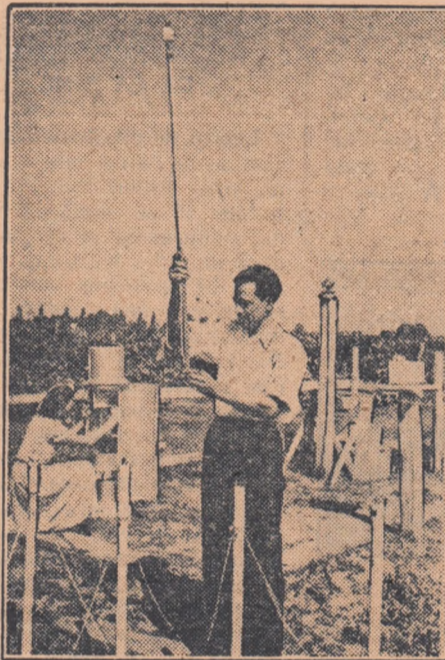
La Stațiunea Experimentală Viticolă, cu aparate de precizie se măsoară temperatura pământului în adâncime.
