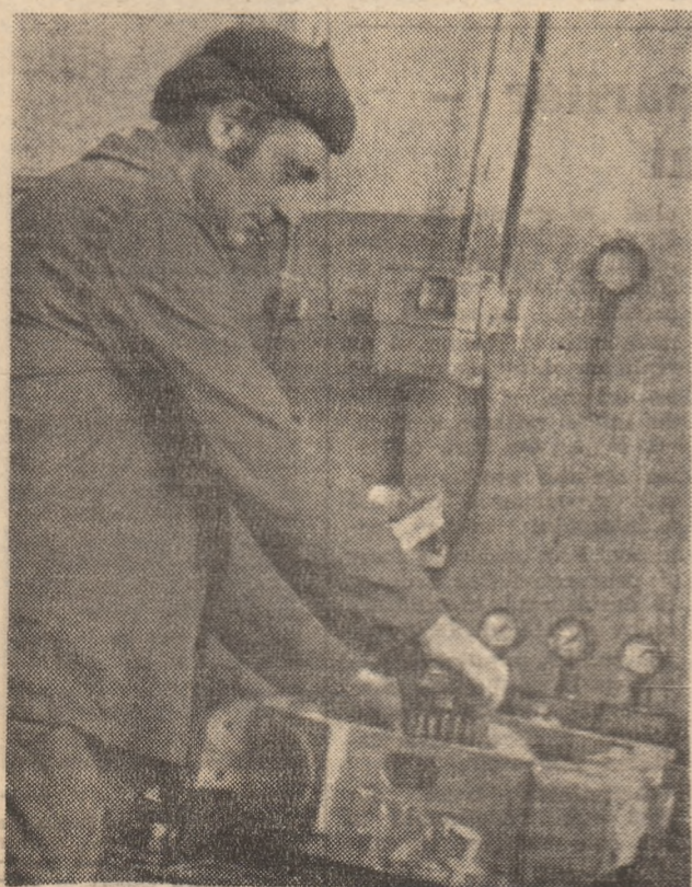
S.M.A. Hațeg — Centrul de reparații. Mecanicul Abel Leja execută reparații la sistemul hidraulic de la tractor.
