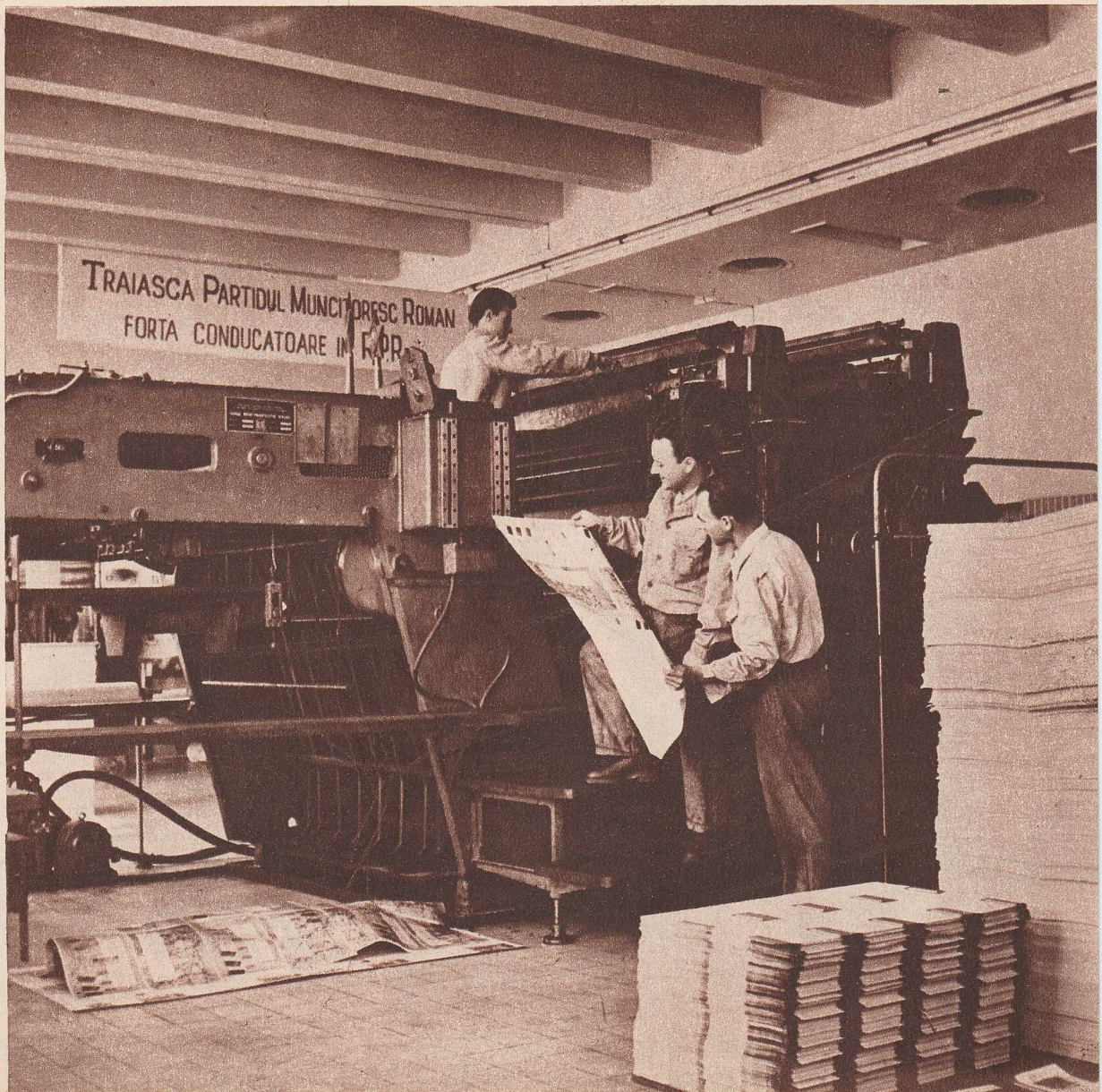
Sînt frumoase planșele artistice, dar tipărițul lor pretinde multă atenție. Mașiniștii de la secția offset, Petrescu Gheorghe și Ștefan Mitică cercetează în fiecare clipă calitatea planșelor, pentru ca nu cumva una din cele zece culori să se suprapună greșit.
