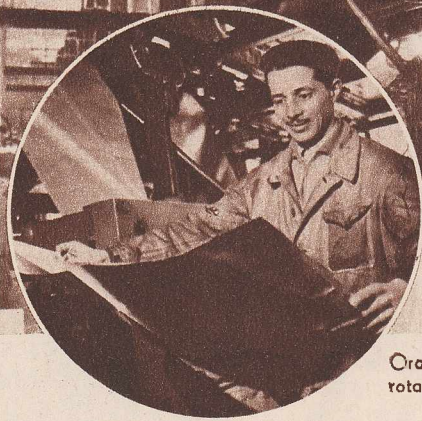
Sînt frumoase planșele artistice, dar tipărițul lor pretinde multă atenție. Mașiniștii de la secția offset, Petrescu Gheorghe și Ștefan Mitică cercetează în fiecare clipă calitatea planșelor, pentru ca nu cumva una din cele zece culori să se suprapună greșit.
