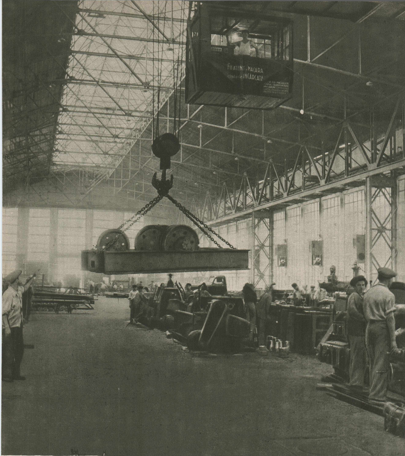
Oamenii muncii de la uzinele producătoare de mașini și utilaj petrolifer „Gheorghe Gheorghiu-Dej” din Tîrgoviște și-au luat angajamentul să obțină noi succese în producție în cinstea zilei de 23 August. Munca lor este ușurată de procesul de mecanizare a uzinei, în permanentă dezvoltare. În hala metalică gigantică macara a podului rulant poate transporta rapid piese în greutate de câteva zeci de tone.
