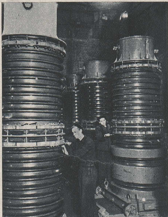
La uzina „Electroapparat” din Leningrad. Se montează, în serie, secțiuni ale unor transformatori de înaltă tensiune.
