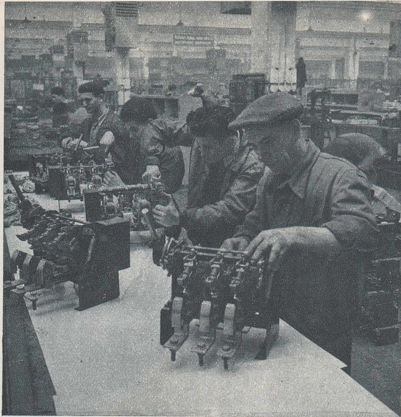
Brigada lui Gheorghe Mihoc — în cap cu moș Marinescu — lucrînd la montarea unui tip de întrerupător automat cu funcționarea în aer.
