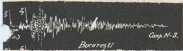
registrarea seismografică a unui cutremur, la Observatorul Astronomic din București.
