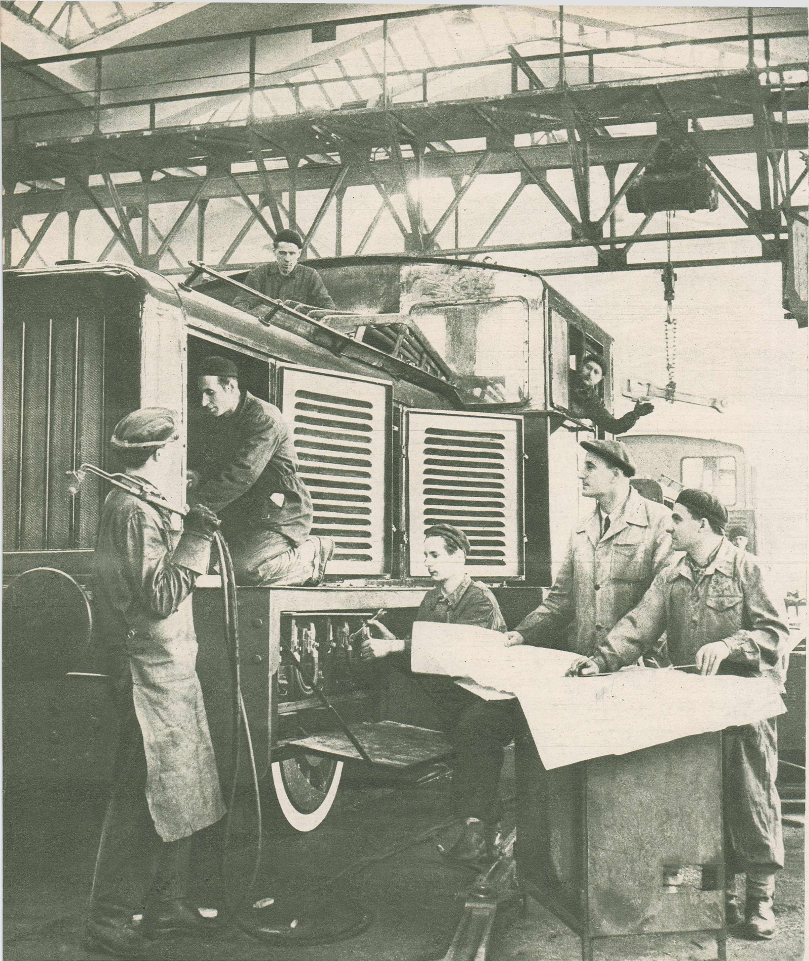
O ultimă revizie și prima locomotivă Diesel de cale ferată normală, de 120 CP, lucrată în 1956, va ieși pe porțile uzinelor „23 August”.
