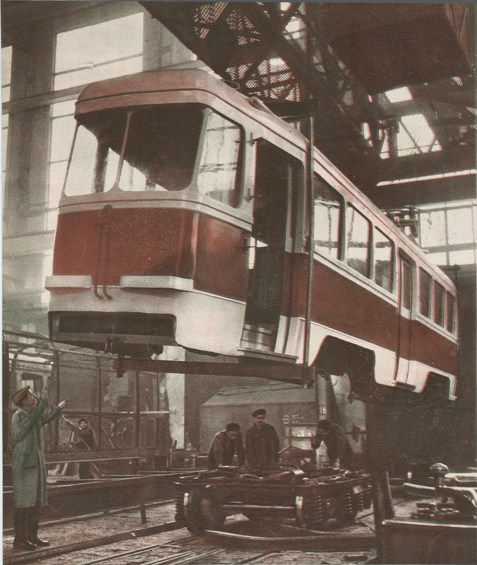
La secția electrovehicule a uzinelor „Electroputere” din Craiova se montează un vagon de tramvai pe boghieri.
