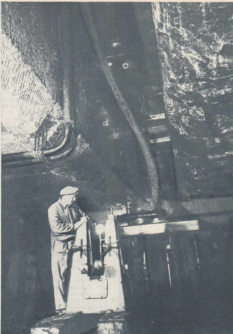
În afara sondelor de la suprafață, în interiorul minei, la o adâncime 150 m, există sonde de extracție. Tuburile pătrund în straturi, le spală și duc apa sărată spre fabrica de sodă.
