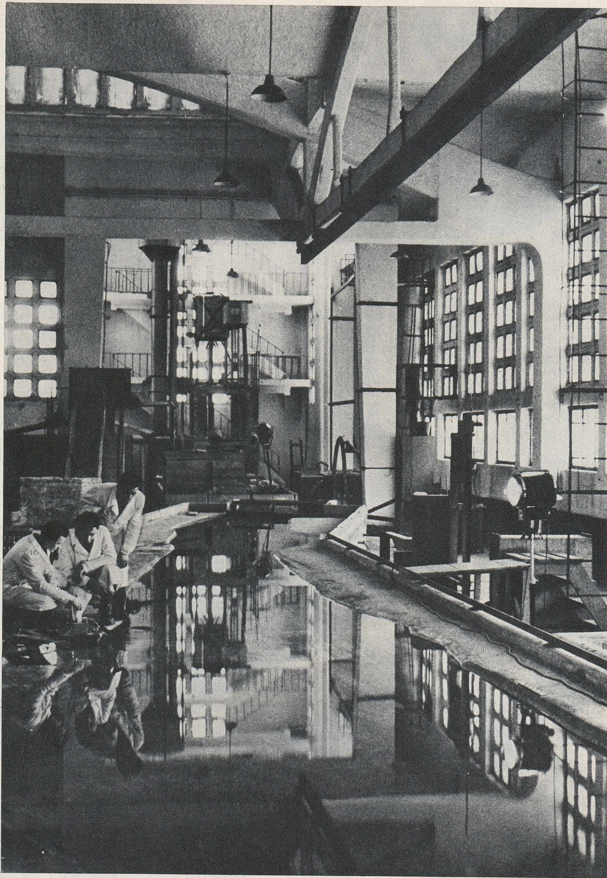
Se fac măsurători pentru stabilirea vitezei „Dunării“ într-un punct dat al cursului ei.
