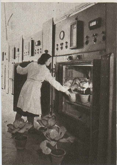
↑ FITOTRONUL SOVIETIC este noua staune de climă artificială care a intrat de îndată în funcțiune la Moscova. Aci se efectuează cercetări științifice în domeniul experimentării plantelor, pentru sporirea productivității culturilor agricole. În fotografie: laboratorul de rezistență la frig a plantelor.
