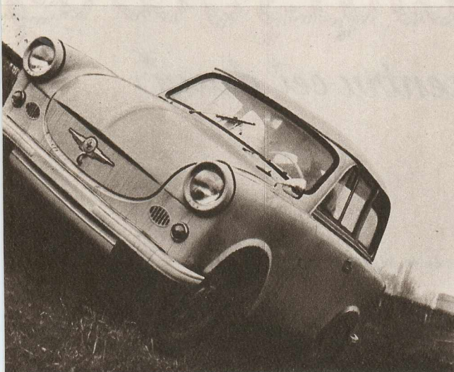
ATELIT („Trabant“) se numește ultimul tip de turism, produs fabricii de automobile din Zwickau (R. D. Germană). Mașina are roșeria din material plastic, un motor de 18 C.P. și un consum de benzină de 6 litri la suta de kilometri.
