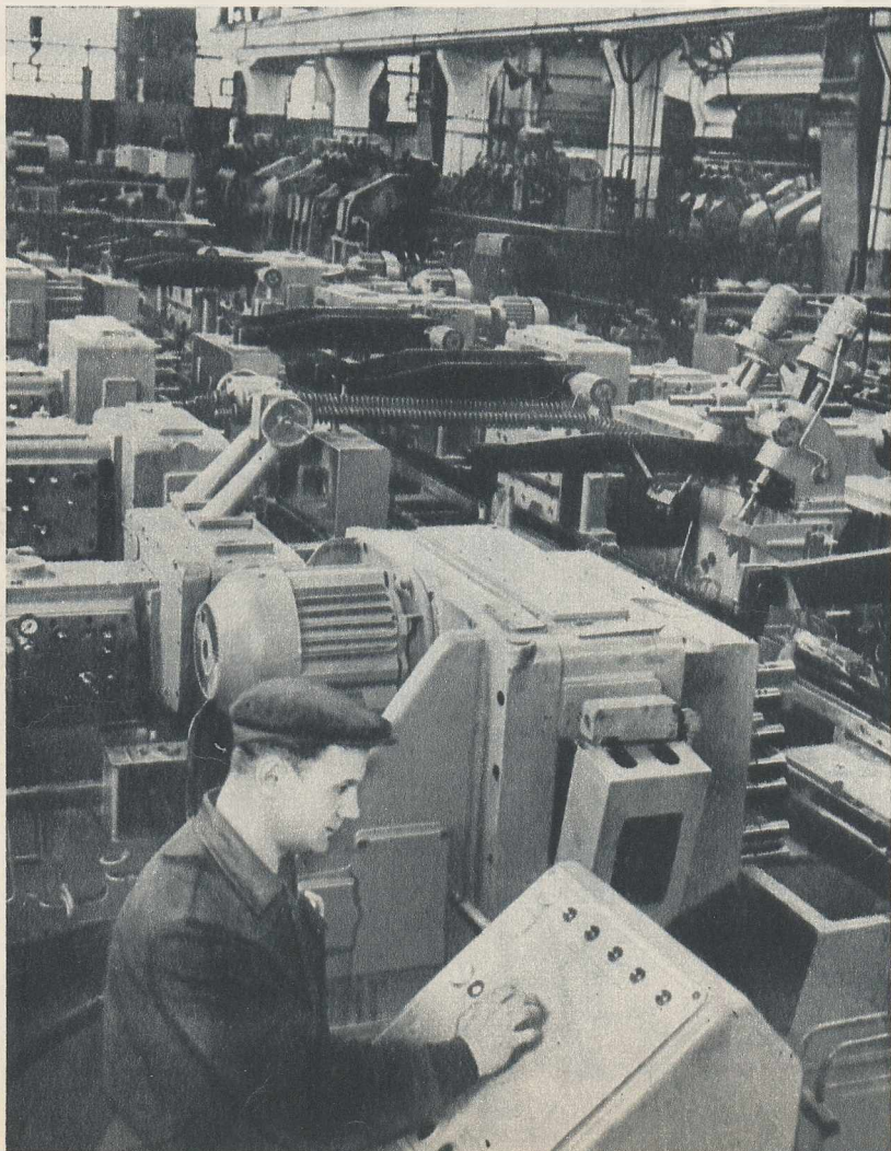
← Procesul de automatizare a industriei este în plină dezvoltare în U.R.S.S. În fotografie, un aspect al automatizării la Uzina „Sergo Ordjonikidze”, din Moscova. Noua linie automată este deservită doar de doi oameni și produce 40 de blocuri de cilindri pentru motoare de tractoare, pe oră.
