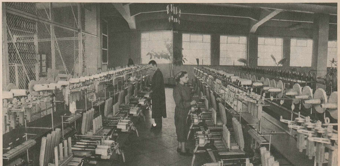
Întreprinderea „Înfrățirea” din Oradea execută o gamă întreagă de mașini-unelte. Modernizarea procesului de producție este principala grijă a întregului colectiv. Prin procedeele de mecanizare în curs de aplicare se vor economisi 150 tone de metal. În fotografie: un nou lot de mașini de găurit „A-3” se află la ultimul control de calitate.
