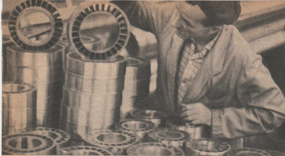
Uzinele „1 Mai” din Ploiești produc în serie turbine de foraj. O sută din aceste piese, pe care ni le arată un tehnician al uzinel, formează — înșirate pe un ax — rotorul turbinei.
