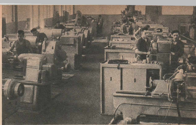
Secția scularie a uzinelor „Electroputere” din Craiova. Aci, printr-o mai judicioasă amplasare a utilajelor, indicele de folosire a spațiului de producție a crescut cu 26%.
