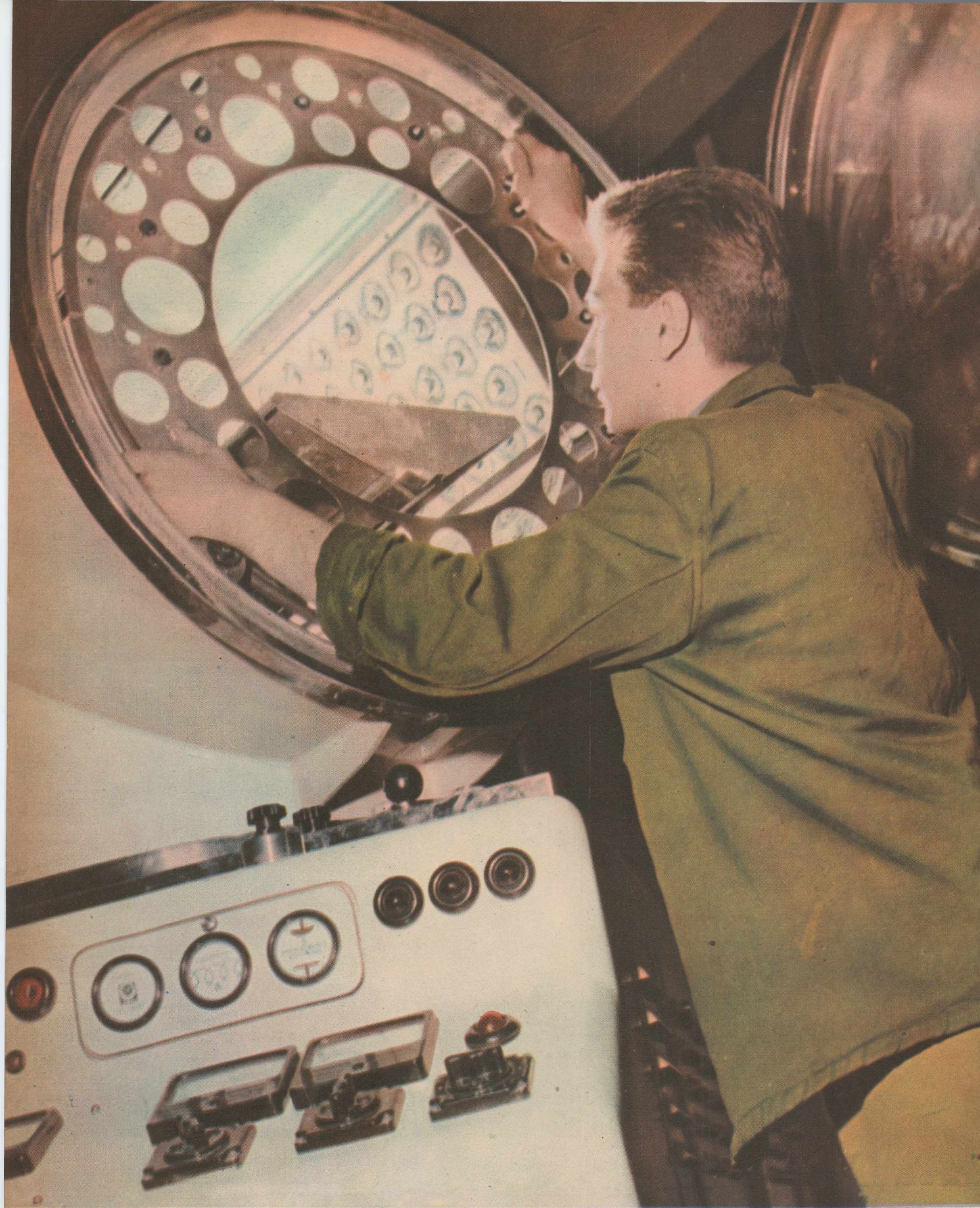
În pas cu tehnica cea mai înaintată, se folosesc cele mai moderne utilaje. În fotografie, mașina de metalizat suprafața materialelor plastice.
