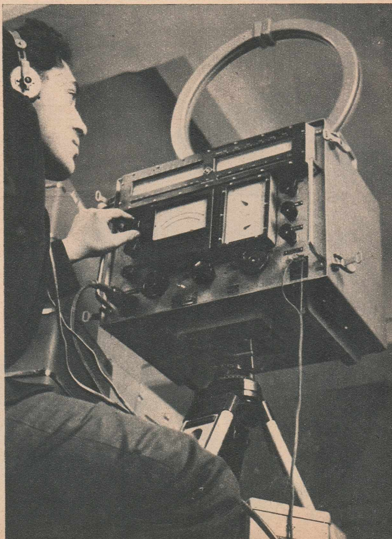
Unul din măsurătoarele de cîmp electromagnetic de la Institutul politehnic, cu care se vor înregistra perturbațiile ionosferei.
