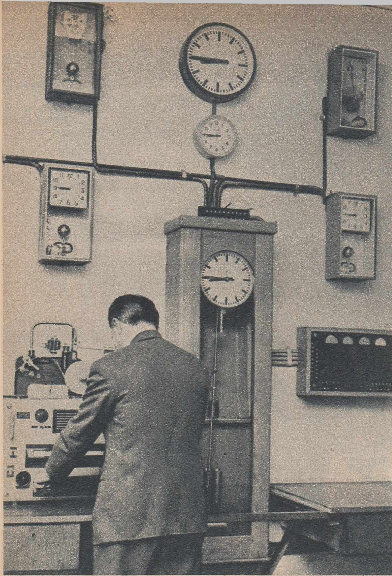
ETALOANE SECUNDARE DE TIMP. Aici, în laboratorul de timp, se „conservă” secunda, care se transmite lucrătorilor institutului.
