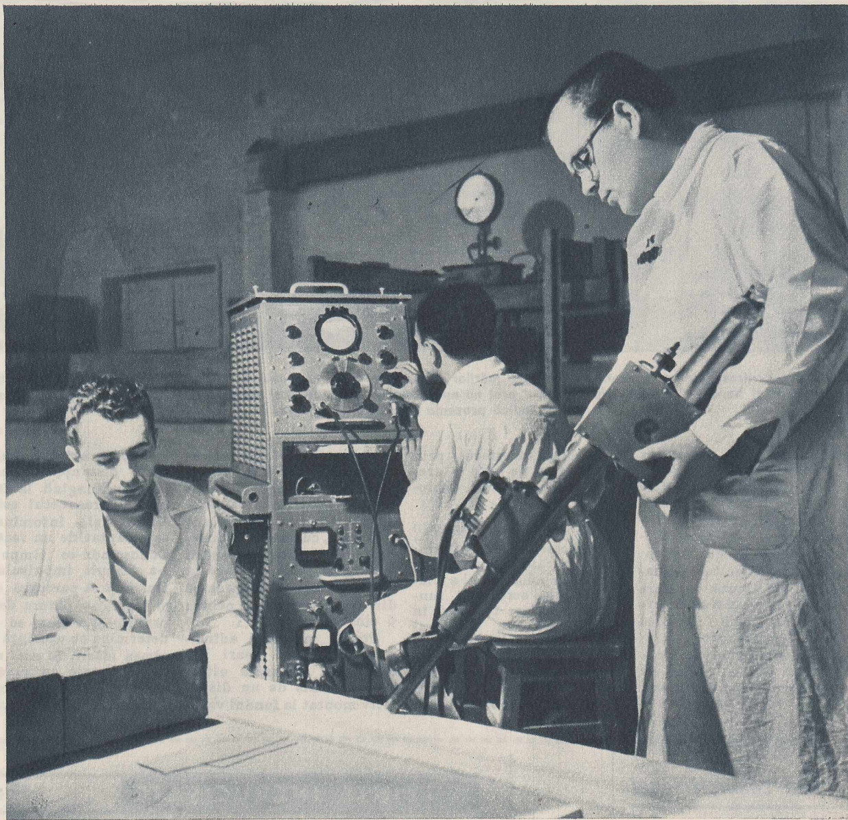
După cum arată această fotografie — făcută la Institutul de cercetări în construcții și economia construcțiilor — utilizarea ultrasunetelor oferă o metodă simplă și practică pentru cercetarea rezistenței betonului. Spre deosebire de procedeele folosite pînă în prezent, noua metodă poate fi utilizată nu numai în laborator, ci și la construcțiile în curs de executare.
