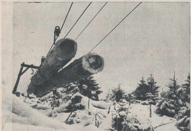
În ciuda abundenței de zăpadă ce a căzut în ultima vreme, la exploatarea forestieră Cocos din munții Gurghiului (Regiunea Mureș Autonomă Maghiară) munca se desfășoară fără întrerupere. Cu trenurile C.F.F. sau pe linia funicularului (vezi fotografia) buștenii coboară neconțenit spre întreprinderile pentru prelucrarea lemnului.
