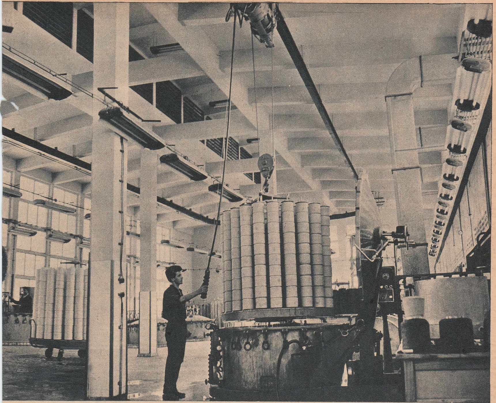
Printr-o singură apăsare pe buton, ajutorul de meșter Aurel Stănescu ridică din autoclavă enormul stativ cu bobine albite. Complexelor agregate de albit nu le sînt necesari mai mult de doi oameni care să le dirijeze.
