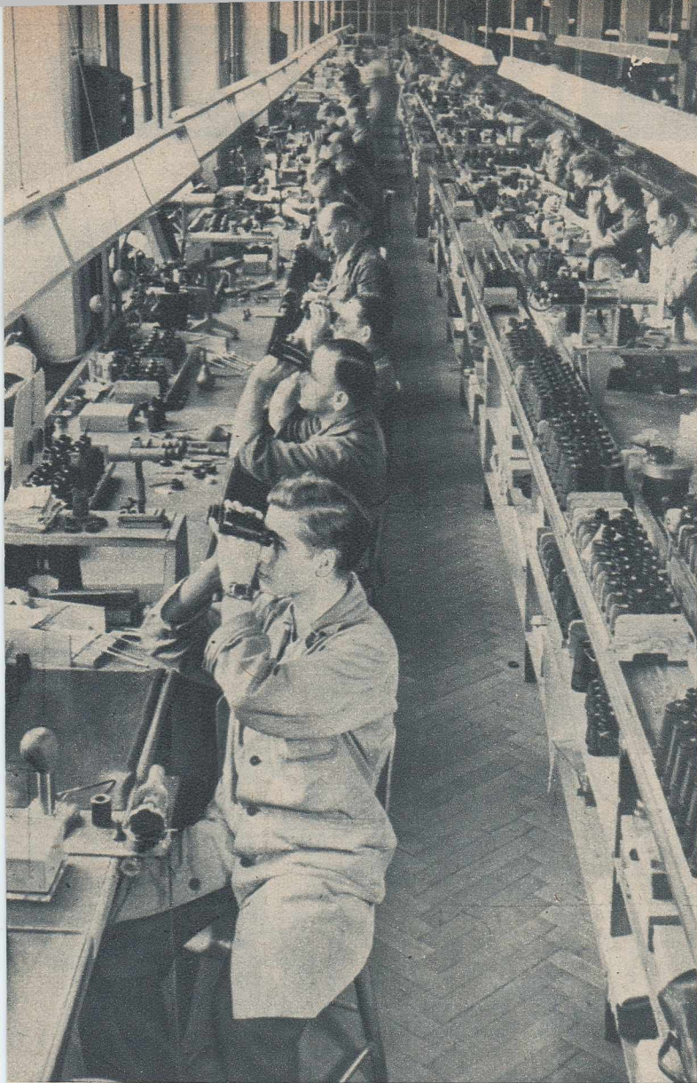
La secția de montaj a binocurilor
