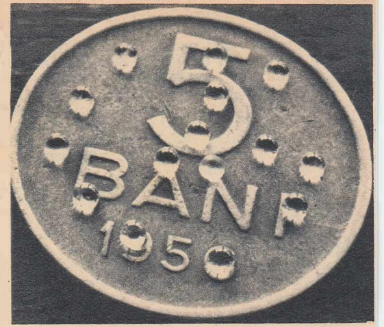
Picături de rouă pe o monedă de cinci bani? Nu: lentilele frontale pentru obiectivul microscopului de laborator ML-3, fabricat în serie de „Industria Optică Română”
