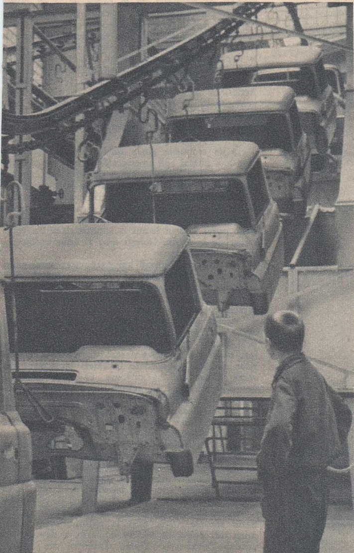
Călătorie spre secția de vopsitorie.
