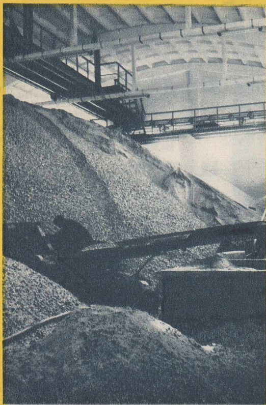
Prima „haltă” într-o lungă călătorie: în spațioasa hală de depozitare a sării de la noua secție de electroliză cu catod de mercur a Combinatului chimic Borzești.
