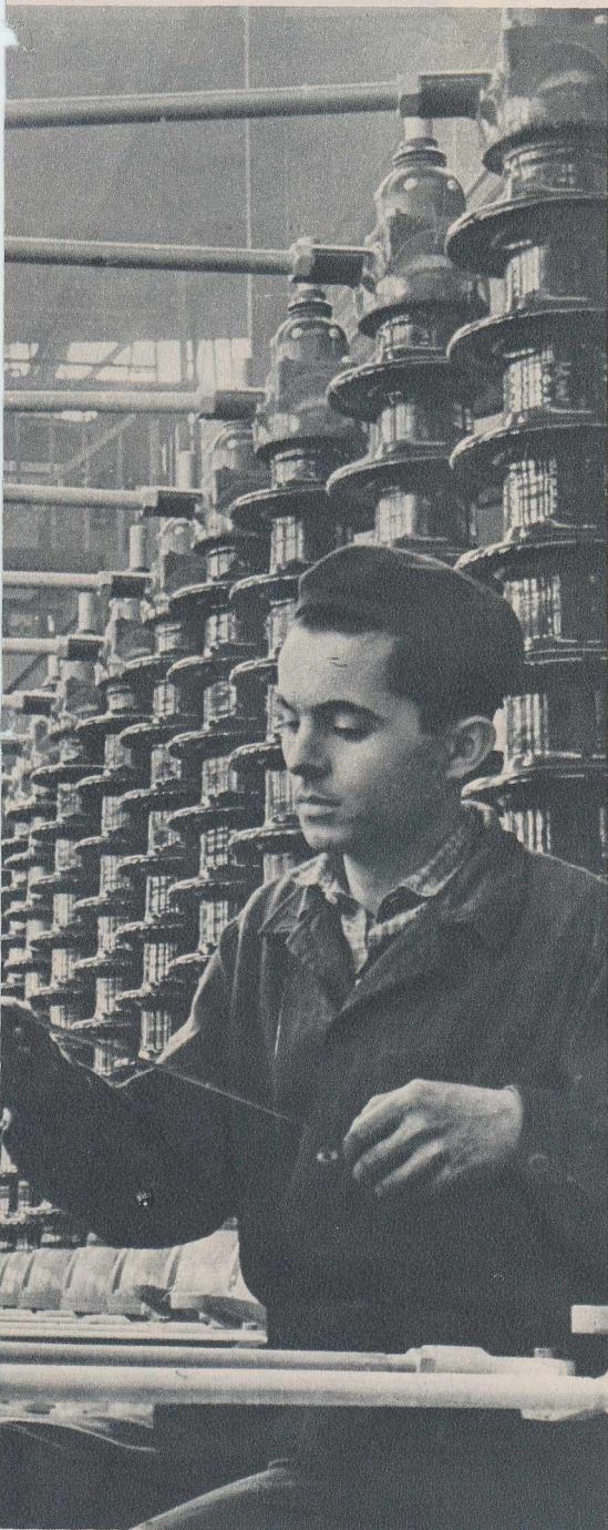
Producția industriei electrotehnice va atinge în viitorul cîincinal cel mai înalt ritm din sectorul construcției de mașini, sporind în medie cu peste 16% anual. Printre principalele producătoare de aparate electrotehnice se numără și uzina „Electroputere”-Craiova. În fotografie: aspect din secția de montaj a separatoarelor de 110 Kv și 1 250 A.
