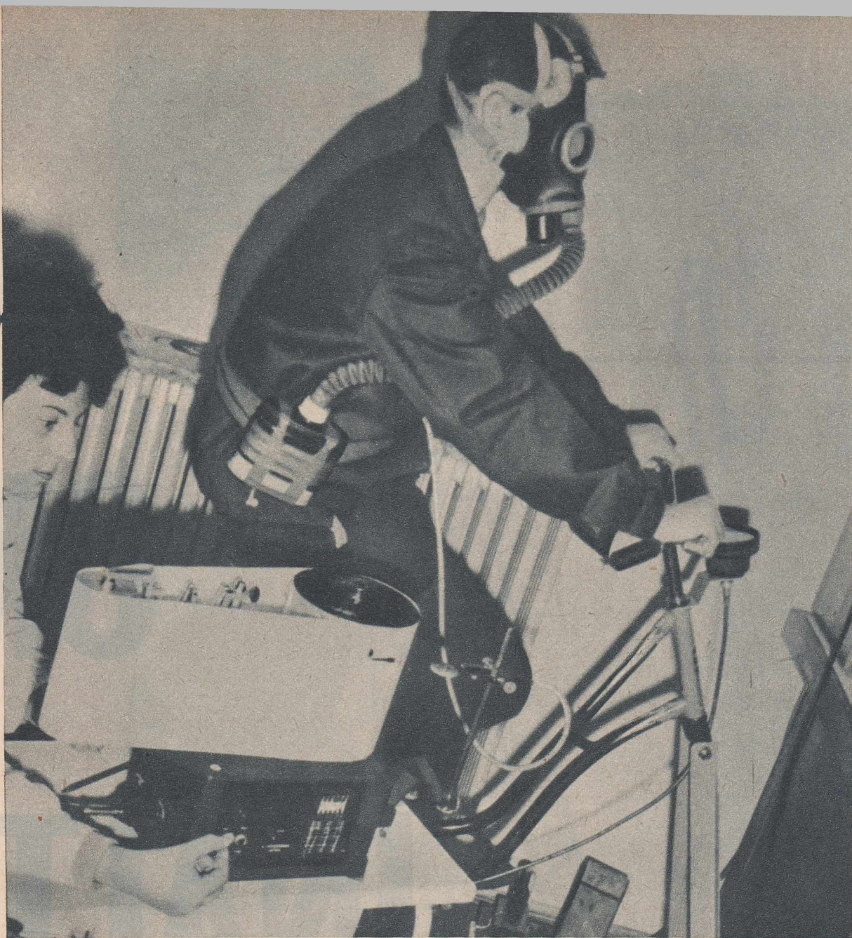
În laboratorul de fiziologie, biologie și igiena muncii, dr. Hilda Herman, cercetător principal, urmărește înregistrarea mișcărilor respiratorii ale unui muncitor care execută un efort purtînd o mască de protecție împotriva gazelor.
