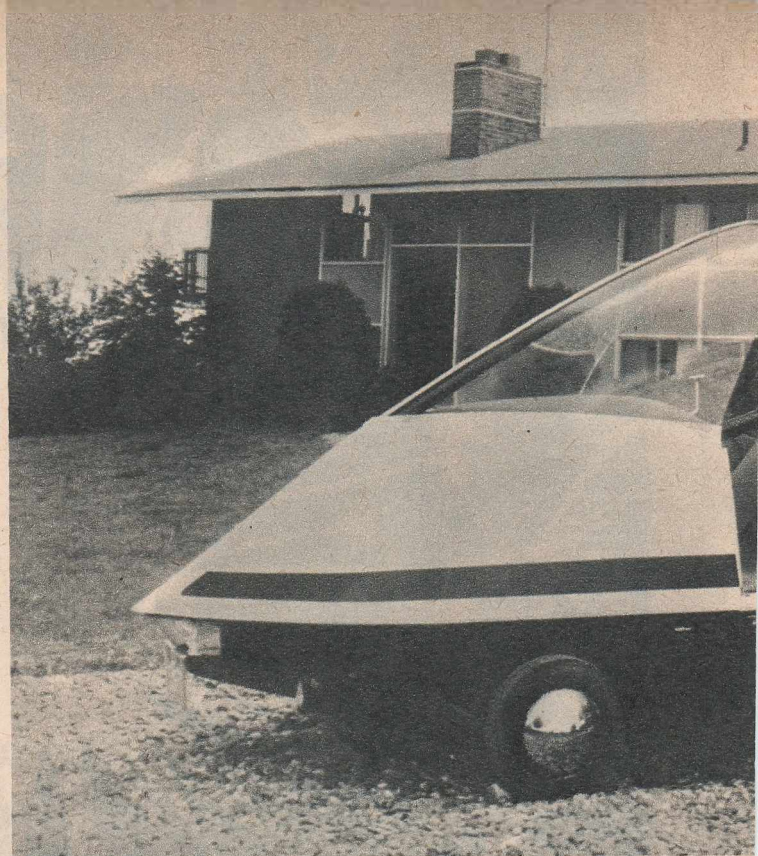
Automobilul anilor '70 — mai exact, unul din prototipuri — a fost de acum construit. Acest vehicul cu motor electric poate călători atît pe drumuri obișnuite (stînga) cît și pe șosele prevăzute cu monorai (dreapta), de-a lungul cărora el se deplasează cu viteză extrem de mare. Controlul circulației se realizează electronic și accidentele — după afirmațiile tehnicienilor — sînt excluse.
