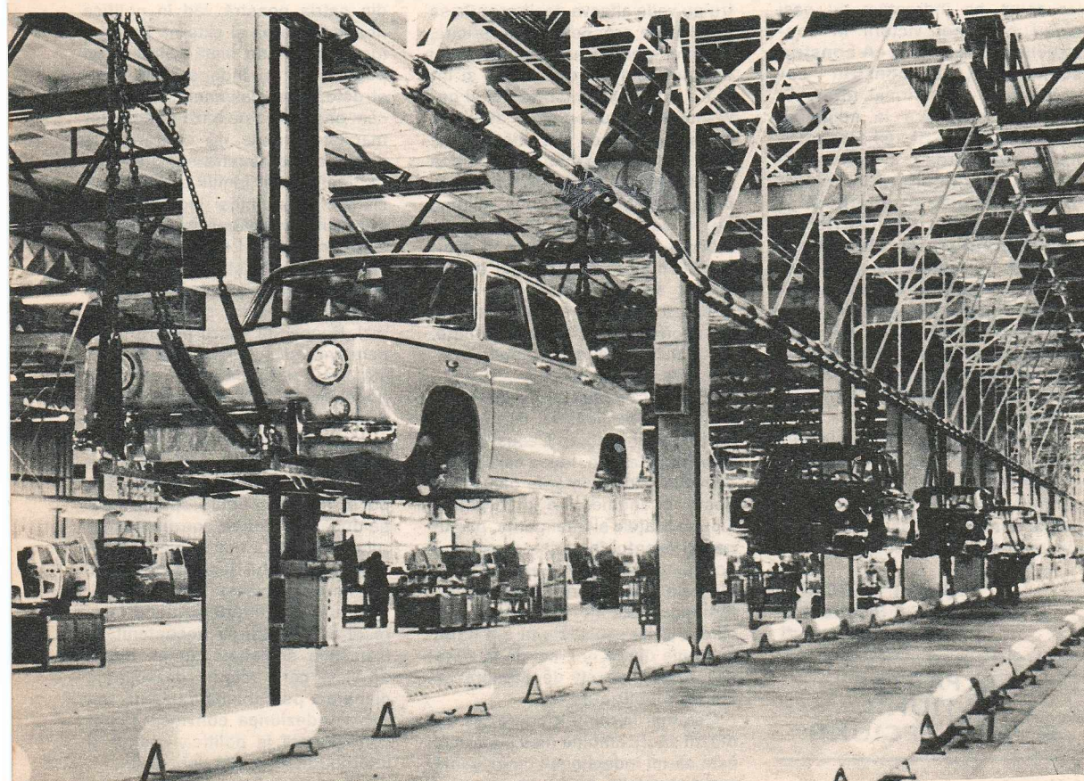
Pe banda aeriană a montajului mecanic caroseriile curg în flux continuu...
