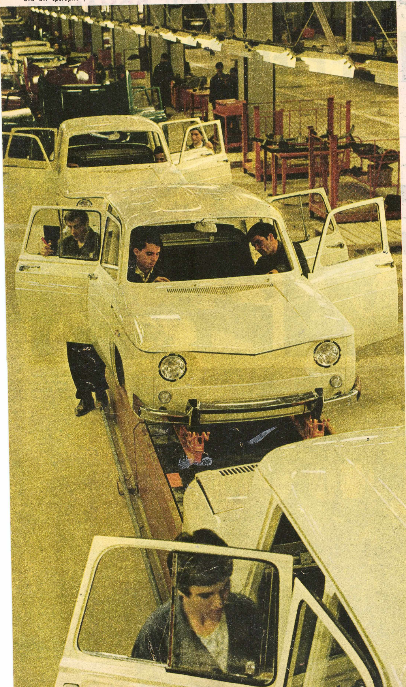
Una din operațiile finale: se montează tapițeria.
