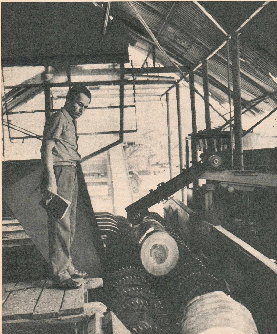
Inginerul Traian Lupescu este unul dintre membrii colectivului care a proiectat și executat această instalație ce a dus la modernizarea procesului de producție în decojirea buștenilor pentru derulaj la fabrica de plăcși.
