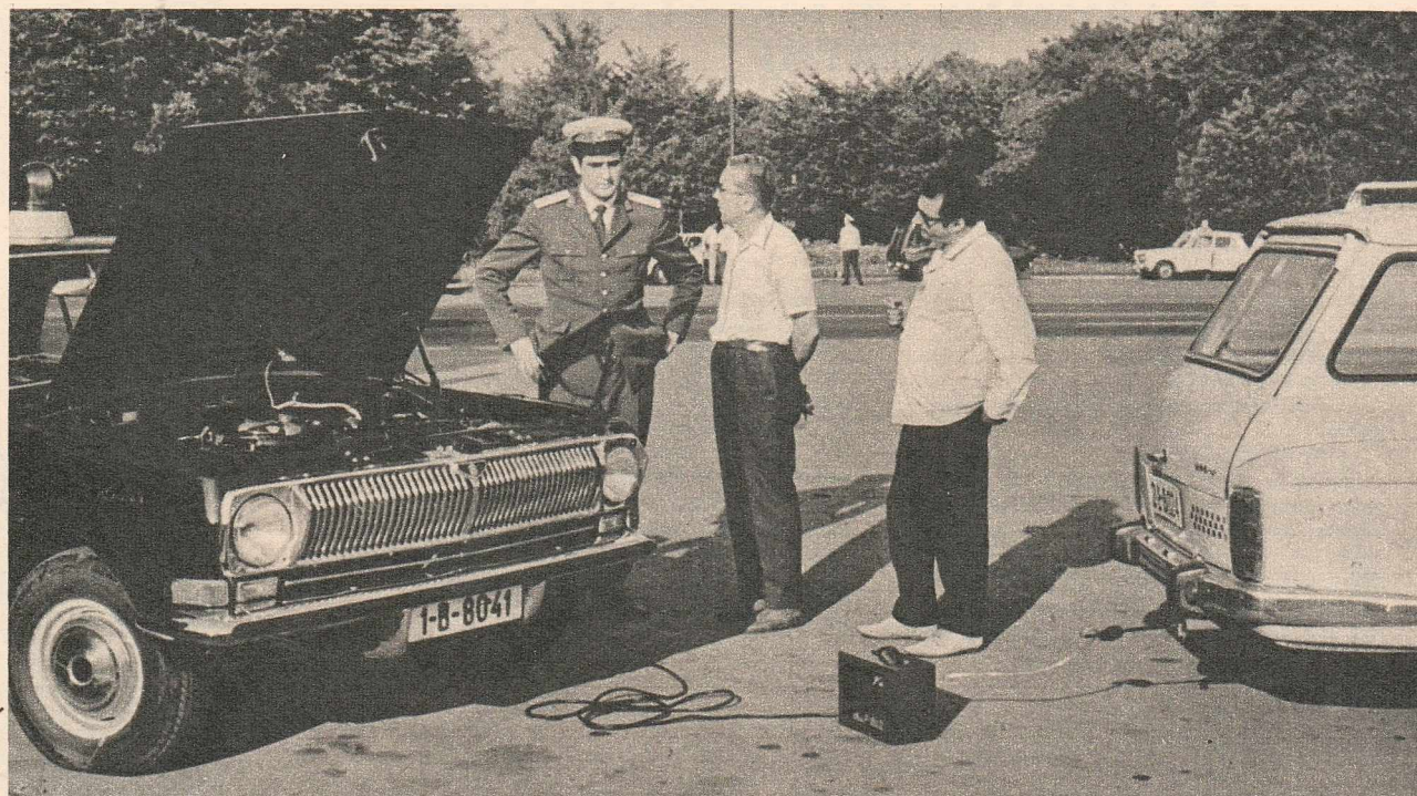
Aparatul Bosch a intrat în funcțiune. El stabilește procentajul de monoxid de carbon emanat de țevile de eșapament ale autovehiculelor.
