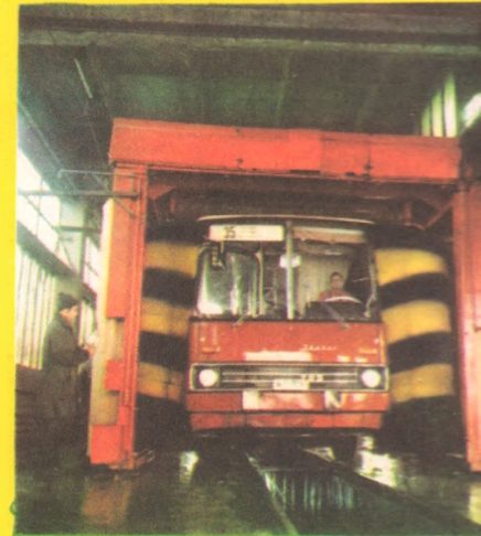
Instalație pentru spălat autobuse
