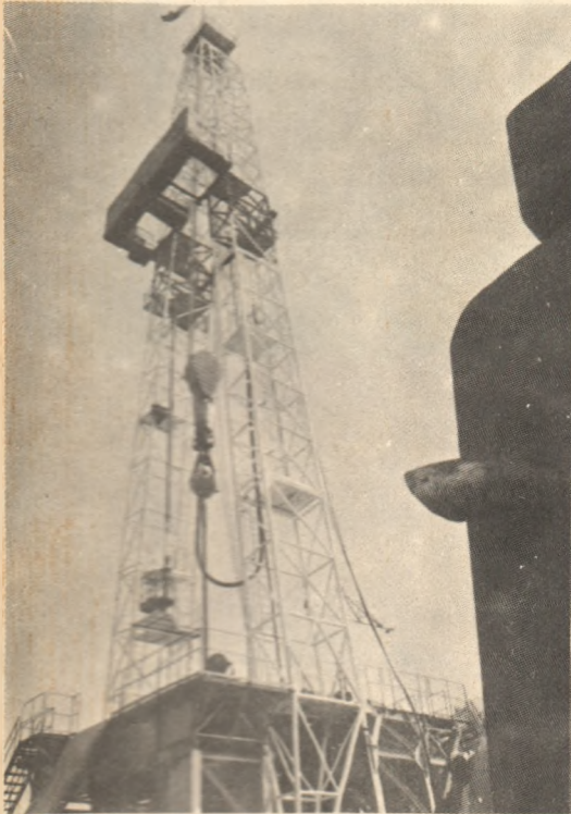
România — un mare producător și exportator de utilaj petrolier de înalte performanțe. Noua instalație de foraj F-400 E.C. pentru adâncimi de peste 7000 m, acționată electric
