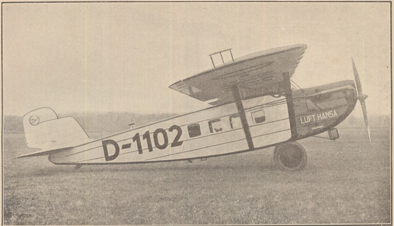
Avion metalic „DORNIER-MERKUR“ de pasageri ultimul model, motor B. M. V. VI 450/600 P. S., cu 8 locuri, introdus pe principalele linii aeriene internaționale
