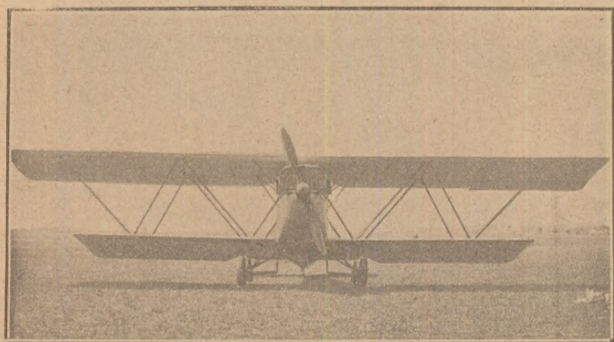
Aeroplanul FIAT R. 22, biplan de recunoaștere din tipul sesquiplan metalic cu aripi împânzite cu motor Fiat A. 22, de 550 H.P. Încărcătura utilă 900 Kgr., lungimea ari-pelor 14 metri, viteza maximă 242 Km. pe oră. Plafonul teoretic 6600. Dotat cu lans bombe, mitraliere, aparat de radio, parașută etc.
