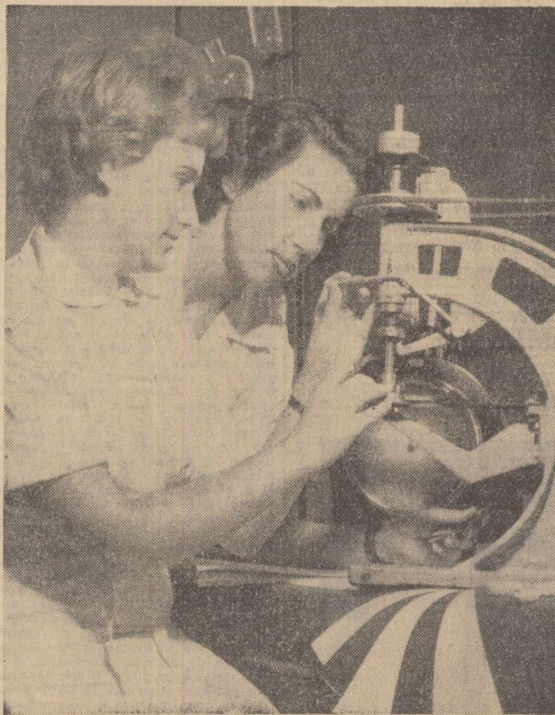
În laboratorul de încercări fizico-mecanice al Institutului de cercetări pielărie-cauciuc, laborantele Simona Broșleanu și Lucia Truță fac măsurători asupra rezistenței peliculei de pe piele la solvenți organici.
