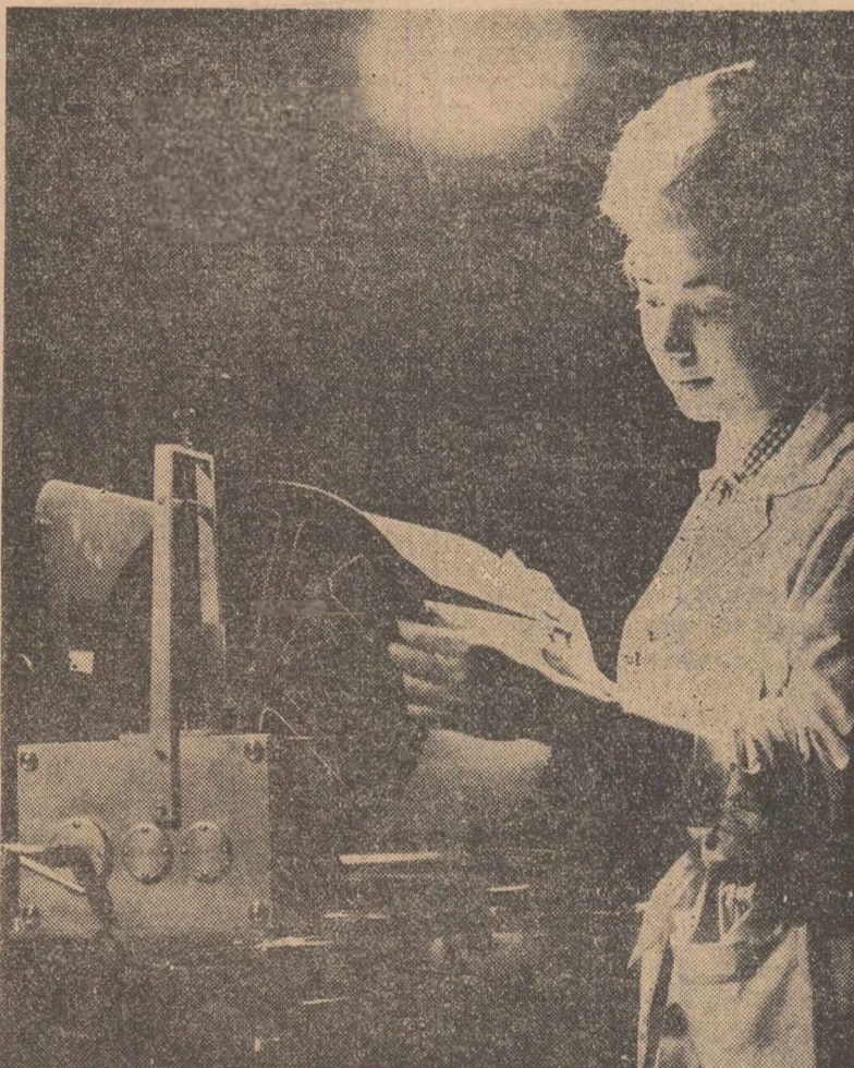
Aparatul din clișeu de mai sus este un pendul care înregistrează pe hîrtie fotografică cele mai ușoare oscilații ale solului. Cu ajutorul acestuia și al altor aparate moderne, cercetătorii Stației seismologice din București întreprind diverse studii privind structura interioară a globului terestru
