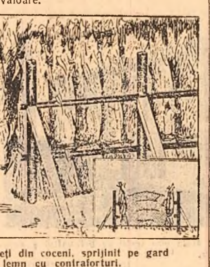
Siloz cu pereți din cocheni, sprînjiți pe gard de lemn cu contralorturi.
