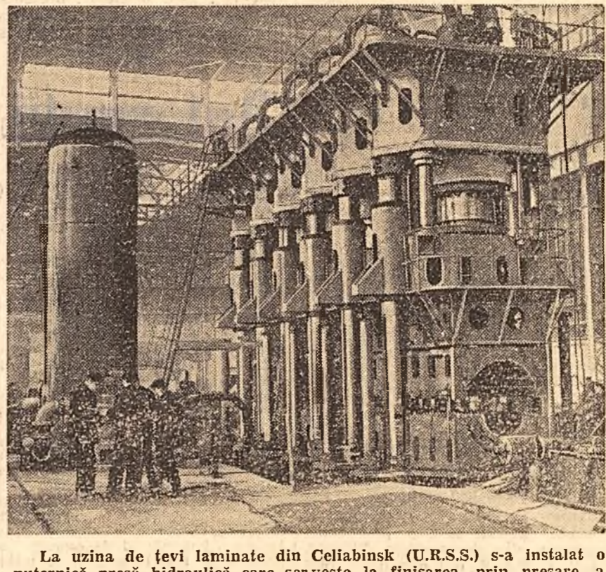
La uzina de țevi laminate din Celiabinsk (U.R.S.S.) s-a instalat o puternică presă hidraulică care servește la finisarea, prin presare, a țevilor laminate de mare diametru.
