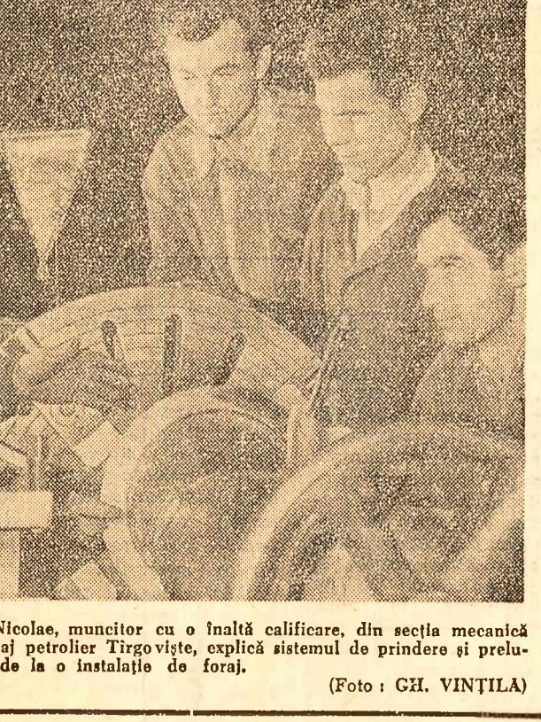
Strungarul Vasile Nicolae, muncitor cu o înaltă calificare, din secția mecanică grea a Uzinelor de utilaj petrolier Tirgoviște, explică sistemul de prindere și prelucrare a arborelui cotit de la o instalație de foraj. (Foto: GH. VINȚILA)
