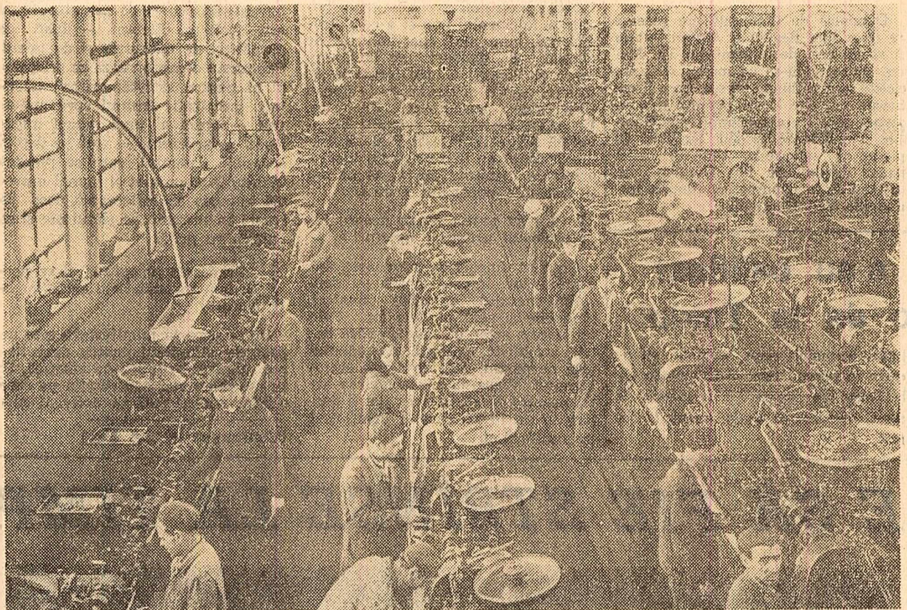
La secția suruburi a fabricii „Muncitorul liber” din Bacău se desășoară o largă acțiune de modernizare a mașinilor și tehnologiei. În ultima vreme, prin modernizarea operațiilor de debitare, presare, filetare și introducerea transportului pe bandă rulantă, productivitatea muncii a sporit cu aproape 2 la sută față de plan
