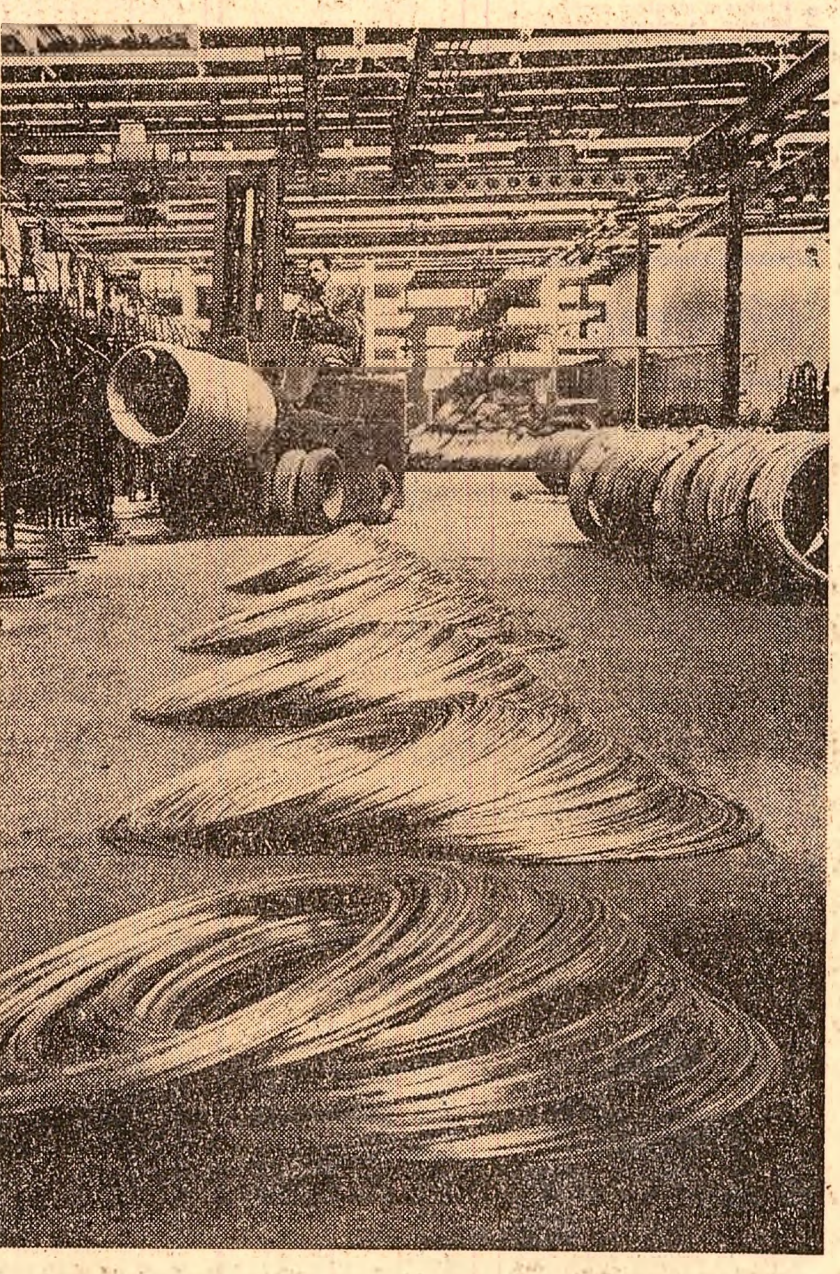
La Uzina de sîrmă din Buzău a intrat în exploatare sectorul de trefilaj și fabricat sîrmă pentru electrozi. De asemenea, se efectuează montajul la cele trei linii tehnologice dotate cu instalații și utilaje automate. În fotografie: Un aspect al liniei de zincat sîrmă
