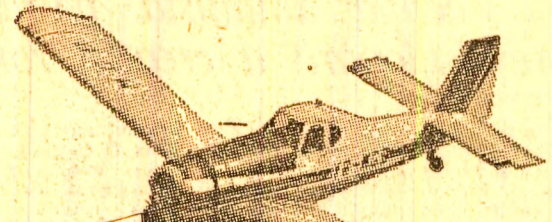
IAR 827 TP. Monoplan cu o construcție integral metalică. Cu unul sau cu două posturi de comandă. Conceput ca avion agricol, el poate fi echipat cu instalații pentru pulverizarea substanțelor chimice lichide ori sub formă de pulberi. Capacitatea rezervoarelor de substanțe: 800 kg. Viteza de croazieră: 193 km pe oră. Viteza în misiuni agricole: 145-180 km pe oră. Plafon practic: 4 500 m. Autonomie de zbor în misiuni agricole: o oră și jumătate.
