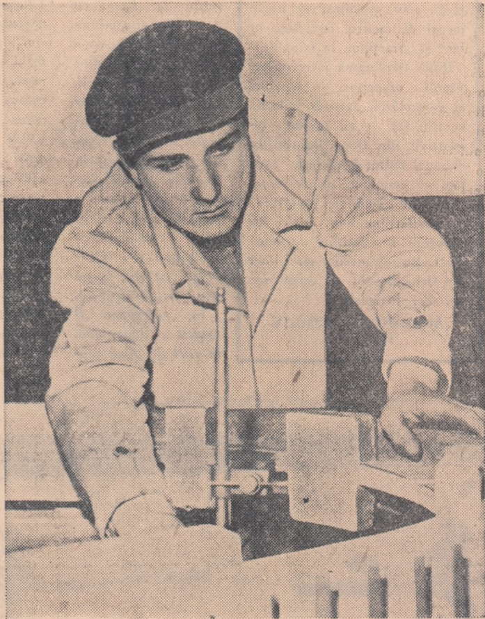
Ulemistul Gheorghe Iftimie din secția mecanică a Atelierelelor navale „23 August” din Constanța, este frunțos în muncă. Iată-l lucrând la trasarea unor coroane dințate pentru malaxorul de bitum.
