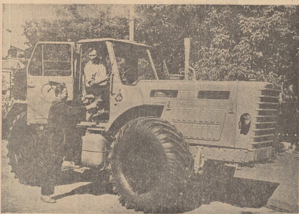
La secția experimentală a Uzinelor de tractoare din Harkov (U.R.S.S.) a intrat în rodaj tractorul „T-125” cu un motor Diesel de 130 C.P.
