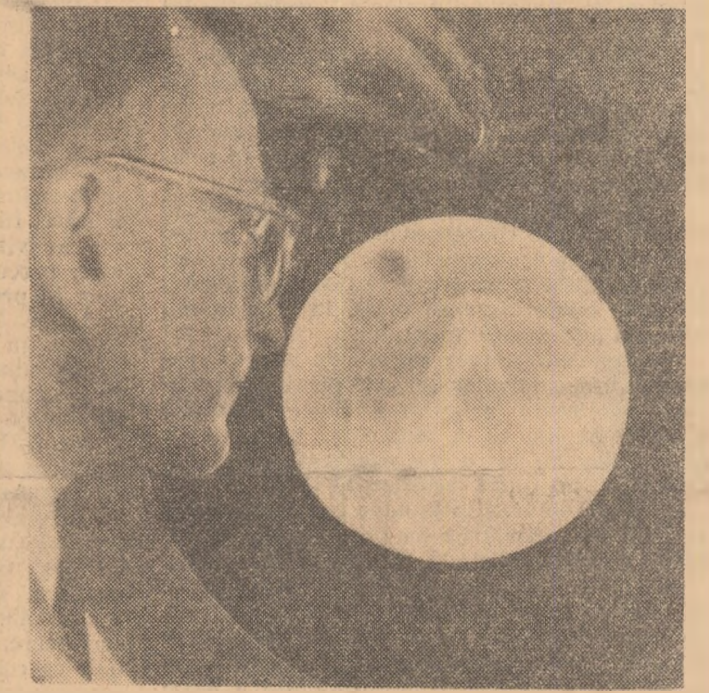
Institutul de studii și cercetări hidrotehnice din Capitală. În laboratorul de foto-elasticitate inginerul Alexandru Constantinescu face studii asupra efortului într-un baraj de beton...
