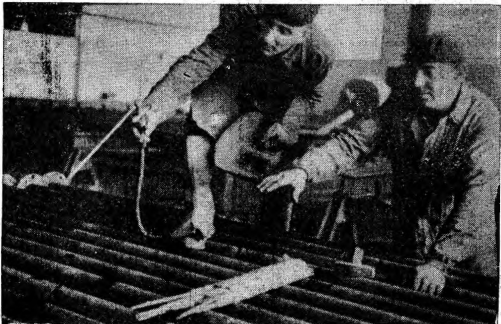
U.R.U.M.P.: În secția construcției metalice a uzinei, sudorul Lungu Dumitru și lăcătușul Costache Dumitru execută flanșarea unui nou lot de tuburi de aer comprimat pentru nevoile exploatărilor miniere.
