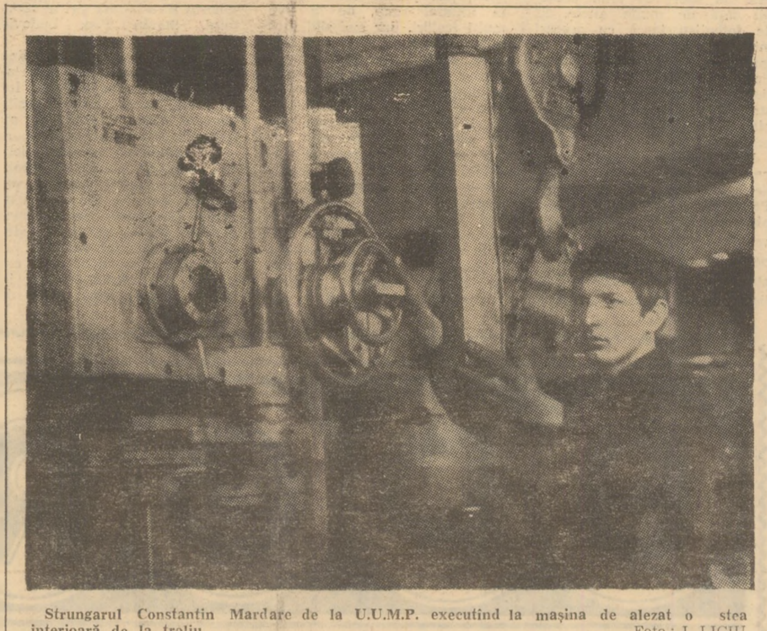
Strungarul Constantin Mardare de la U.U.M.P. executînd la mașina de alevat o stea interioră de la troliu Foto: I. LICIU
